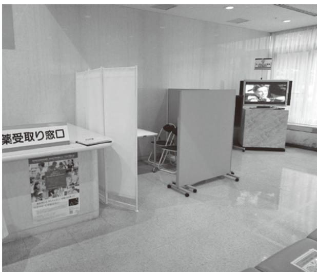
高密度のフェルトボードでできた吸音パーテーションを設置した。フェルトが高音を吸収し反響を押さえる特徴があり、問仕切りと周囲に声が漏れにくくなる効果が期待できる。
